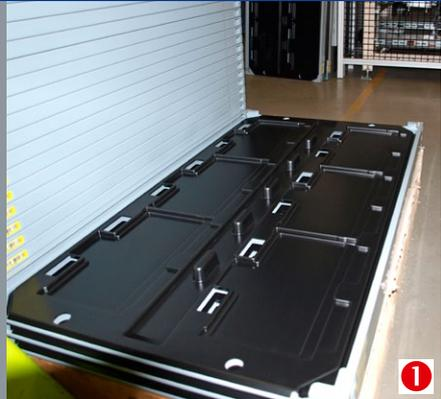
Die Lager- und Transporttablare sind mit einem speziellen Inlay ausgestattet ①, um für die unterschiedlich großen Zelltypen sicheres und schonendes Handling zu gewährleisten.
