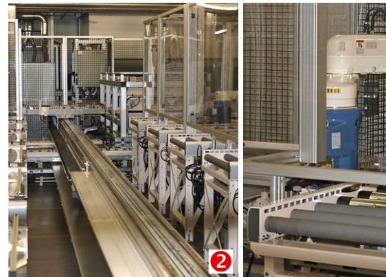
Über Verteilerwagen ② werden die Zellen typenrein vorsortiert und den Robotern ③ zum Einlegen in die Tablare zugeführt.
