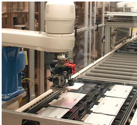
Drei Roboter mit speziellem Greifarm legen die empfindlichen Zellen in Tablare.
