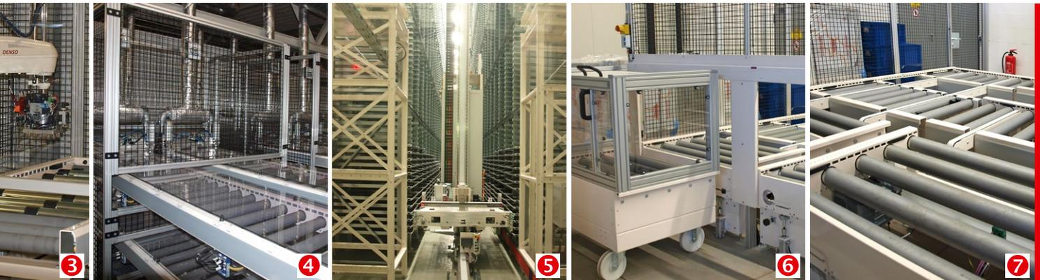
Die Regalbediengeräte der Tablarlager 5 sind mit einer Ziehvorrichtung für schnelle Lastaufnahme ausgestattet und arbeiten durch Zahnriemen in Fahr- und Hubrichtung hochdynamisch. Die Fachpositionierung erfolgt mittels Barcode.
