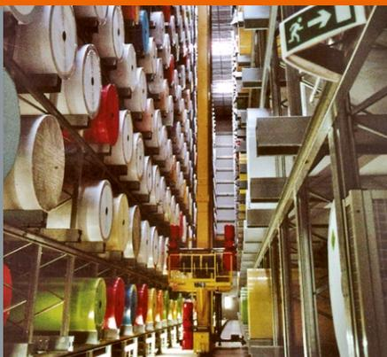
Im neu geschaffenen vollautomatischen Mutterrollen-Lager ① werden an über 6.000 Stellplätzen insgesamt bis zu 26.000 Tonnen Papier in Rollen unterschiedlicher Breite im Mix schonend mit Regalbediengeräten ein- und ausgelagert.
