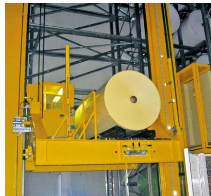
Die Ver- und Entsorgung des Mutterrollenlagers erfolgt mittels zehn fahrerlosen Transportfahrzeugen (FTF) ②. Auftragsbezogen werden die Mutterrollen zeitnah an die sechs Querschneider andiegt, wobei die funkgesteuerte Zustellung die optimale Nutzung und Freihaltung aller Transportwege berücksichtigt.
