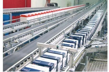
Die Kartons werden pulkweise gefördert, gepuffert und der Palettierung zugeführt. Somit wird eine maximale Durchsatzleistung sichergestellt. *To achieve maximum throughput all cartons are pile conveyed, buffered and supplied for palletization.*
