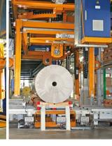
Die beiden Verteilerwagen arbeiten nach dem Mutter-Tochter-Prinzip. Der Mutterwagen bringt die Rolle bis in die Achse des Abwicklers ?. Dort fährt der Tochterwagen rechtwinkelig aus und übergibt die Rolle dem Abwickler. In gleicher Weise können Restrollen vom Abwickler über den Tochter- und Mutterwagen an das Rollenportal zurückgegeben und von dort über den RBG-Übergabeplatz wieder eingelagert werden.
