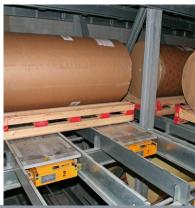
Per Fördertechnik gelangt die beladene Systempalette zum Einlagerplatz, wo sie von einem der beiden Regalbediengeräte 3 übernommen wird.
