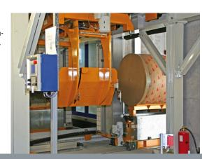
2 Der Hubtisch übergibt die Rollen an ein automatisches Rollenportal, das diese mittig zentriert auf eine materialschonende Systempalette aufsetzt, die aus dem Palettenspeicher zugeführt
