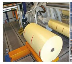
Der Ablauf am Aufwickler für beschichtetes Material erfolgt mit einem weiteren Mutter-Tochter-Verteilerwagen in umgekehrter Reihenfolge. Auch das beschichtete Material wird durch den Mutter-Tochter-Wagen dem Portal zugeführt und von diesem auf dem Einlagerplatz auf eine bereitgestellte Systempalette aufgesetzt.
