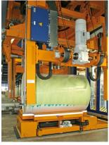
Ausgestattet mit Dornaufnahme, Hub- und Drehvorrichtung kann ein weiteres, individuell für HERMA entwickeltes Rollenportal 6 die Rollen auf Pufferplätzen zwischenlagern oder direkt an die Verteilerwagen zur Versorgung der Rollenabwickler absetzen.
