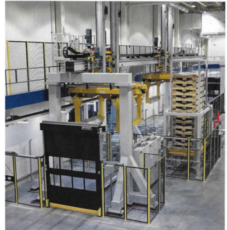
Vollautomatischer, redundanter Rollenmanipulator puffert Rollen und übergibt sie an AGV.
