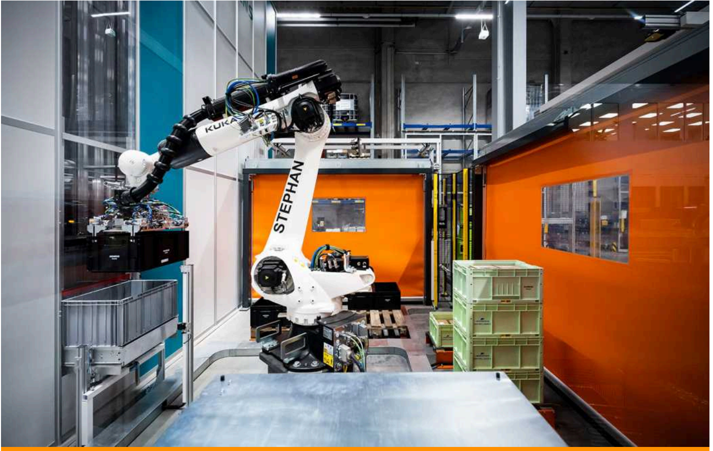
Der KLT-Pickroboter in Aktion beim Einlagern von KLTs aus der Siemens-Produktion. (Bild: Hörmann Intralogistics)
