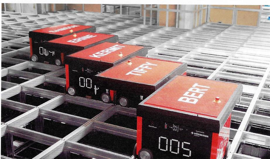
▲ Am Hauptsitz von IDS Imaging Development Systems in Obersulm hat Hörmann Logistik ein vollautomatisches AutoStore-Kleinteilelager mit drei Carousel-Arbeitsplätzen errichtet (Foto: Hörmann Logistik)
