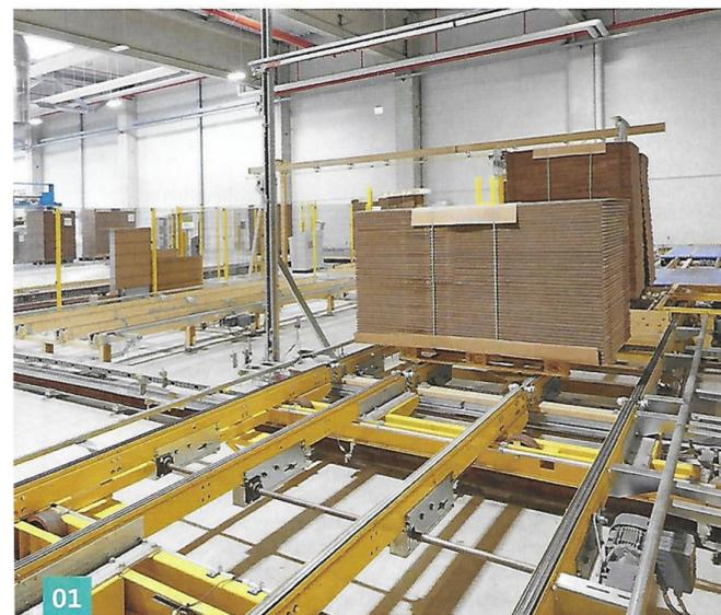
01 Zentrierung, Waage und Konturenkontrolle sowie Querverteilwagen am Anschluss der Produktion
