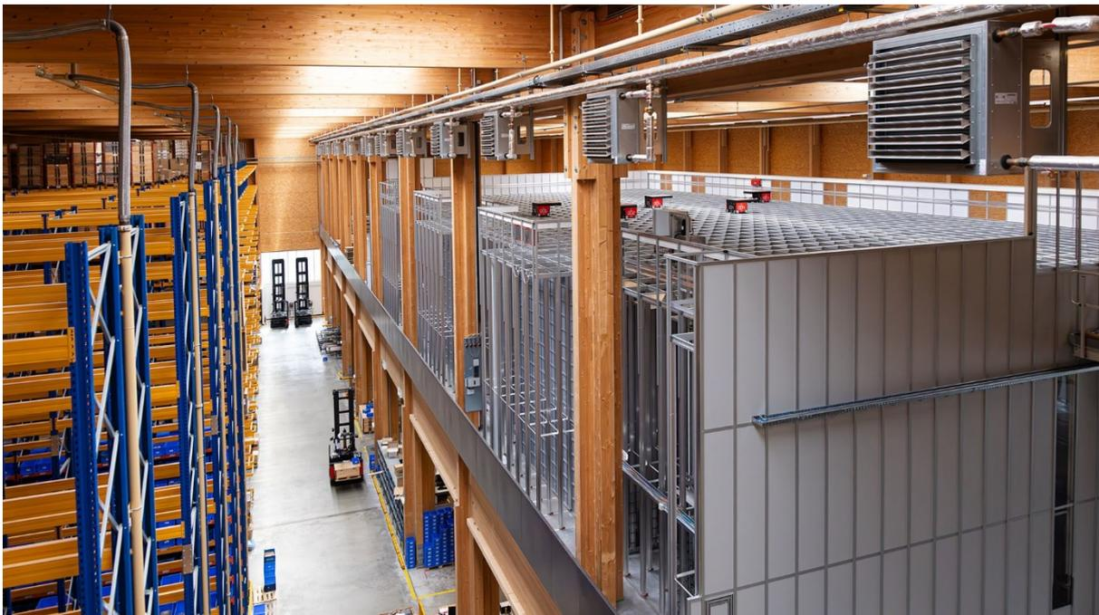
Abbildung 1 cargo-partner geht den Weg der Teilautomatisierung, mit manuellem Schmalganglager und AutoStore Kleinteillager in einer Anlage
