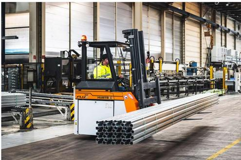
Die neue Flux-Generation von HUBTEX deckt den kombinierten Paletten und Langguttransport in einem Fahrzeug ab. Durch diesen Mischeinsatz als Front- und Seitenstapler eignet sich die neue Baureihe Flux 30 (3 Tonnen) für eine Vielzahl von Branchen.
