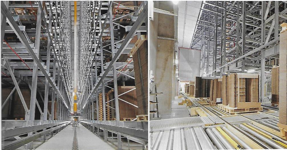
1) 42 Meter hohes 2-Mast-Regalbediengerät (2) Schleife des Hochregallagers mit den Anschlüssen der Ein- und Auslagerung (3) Geschäftsführung und Projektteam: Sascha Zscherpe, Gerhard Bött, Hubertus Kompe und Mathias Kunert (4) Zentrierung, Waage und Konturenkontrolle sowie Querverteilwagen am Ende der Produktion.
